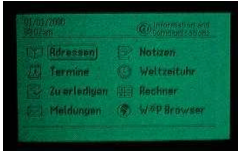
So hell ist das Backlight mit 2 Akkus zu 2,4Volt
